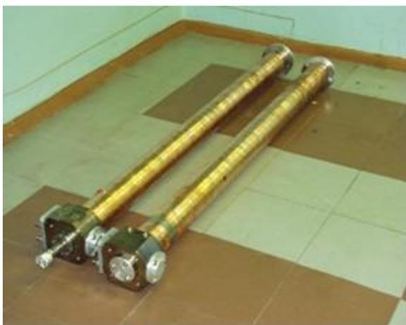
Рис. 3. Половины ускоряющей структуры перед сваркой
