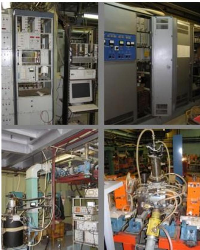
Рис. 2. Элементы ВЧ системы накопителя-охлаждителя: (слева-направо, сверху-вниз) стойка управления ВЧ станции, высоковольтное питание клистрона, клистрон 700 МГц и волноводная система, резонатор накопителя-охлаждителя
