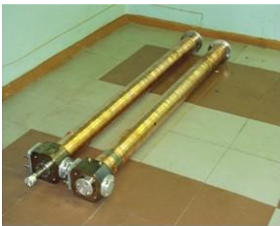
Рис. 3. Половины ускоряющей структуры перед сваркой
