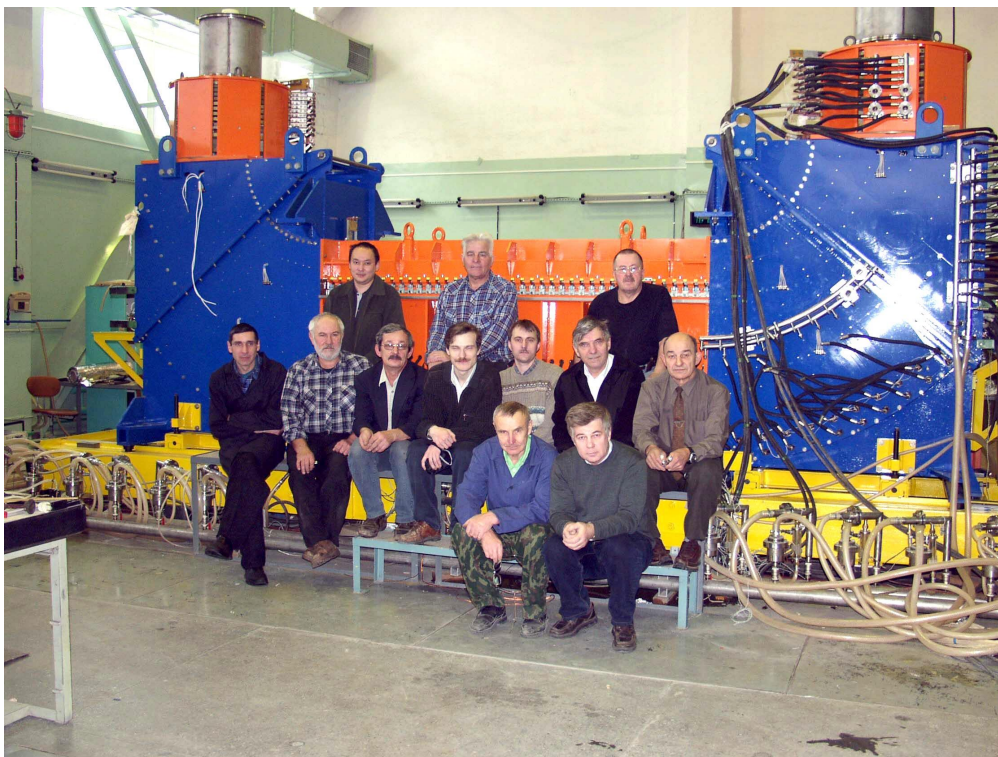
Рис. 2. Установка электронного охлаждения EC-40 для LEIR (CERN)
