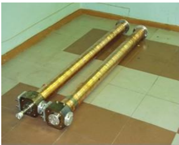
Рис. 3. Половины ускоряющей структуры перед сваркой
