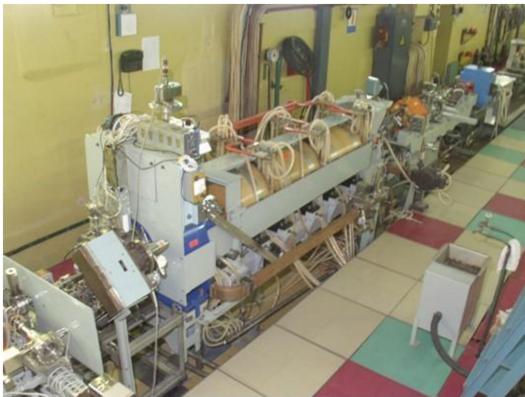
Рис. 1. Позитронная система Инжекционного комплекса ВЭПП-5
